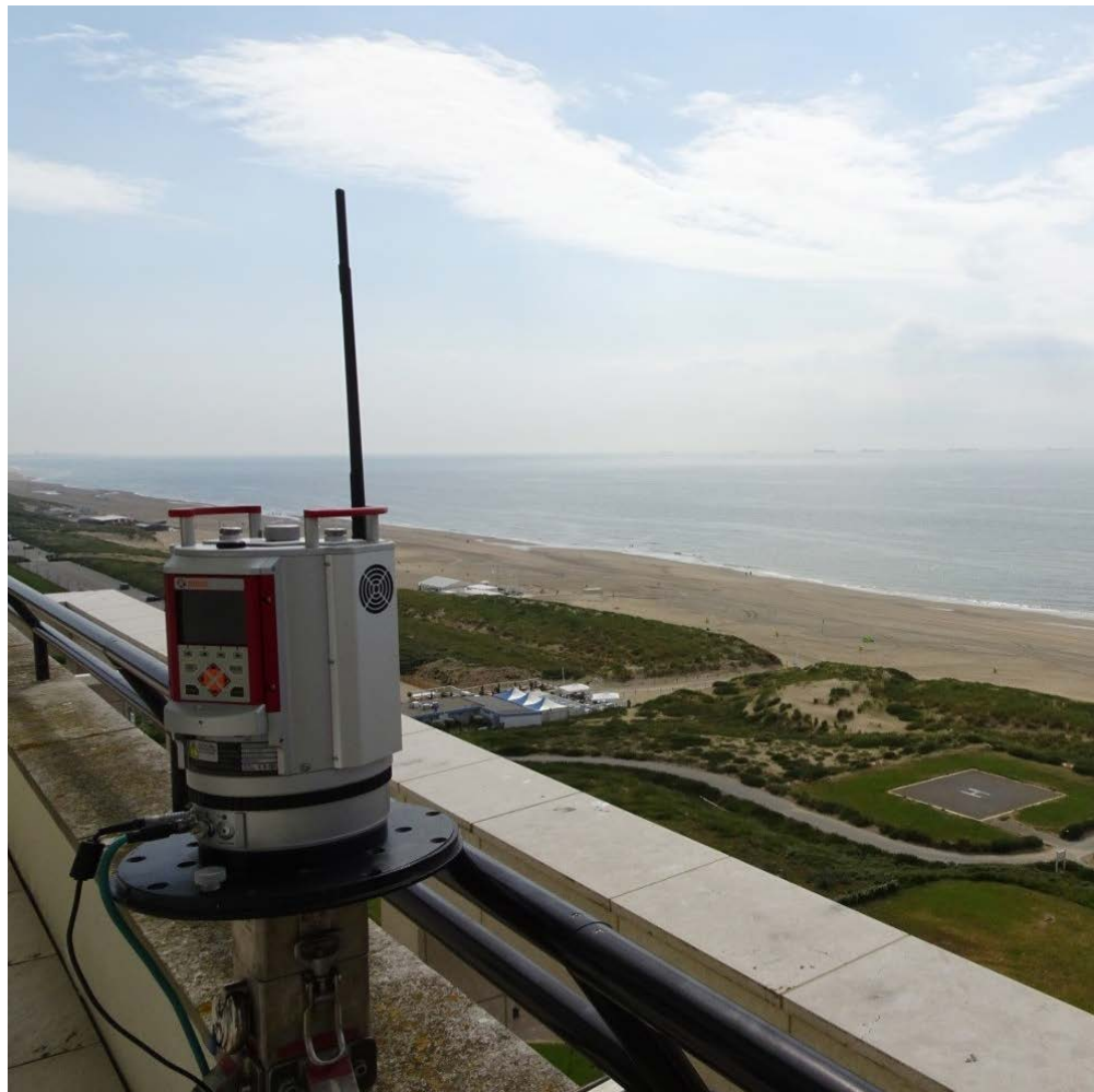
Laserscanner op het hotel Huis ter duin in Noordwijk om het strand en de duinen gedurende twee jaar continu te volgen.
